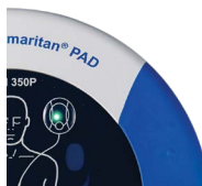
Figur 11. Blinkende grøn LED; ingen handling påkrævet.
